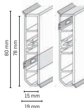
LED-Band unten (Light down) oder LED-Band oben (Light up) möglich
