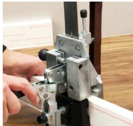
Les blocs d'appui facilitent la pose sur l'outil et permettent de réaliser des coupes propres (sur EP 60/13 flex life, la série Cubu flex life, Hamburger Stil). Les plinthes à âme de bois peu épaisses sont coupées sans blocs d'appui.
