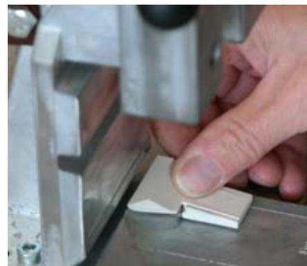
Les blocs d'appui peuvent être utilisés à des fins de stabilisation pour différentes plinthes à âme en bois.
