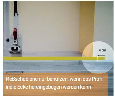
Die Markierung an der Kante der Anschlagfläche ausrichten, Klemmhebel komplett schließen
