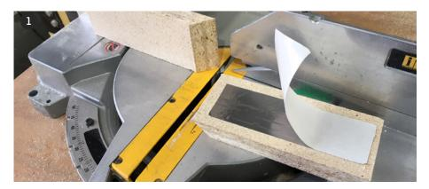
2 Die sogenannten Beilage-Hölzer werden an bedseitig mit einer Vorgefärtigten Gehrung bis an die Schnittkante fixiert.
